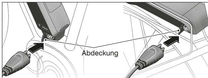
Abb.: B-5 Anschluss des Ladesteckers an die Ladebuchse des eingesetzten Akkus.
