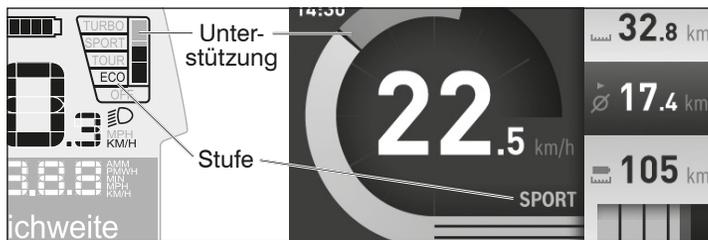
Abb.: B-20 Anzeige für die Unterstützung bei „ActiveLine“ bzw. „PerformanceLine“ (links) und bei „Nyon“ (rechts).
