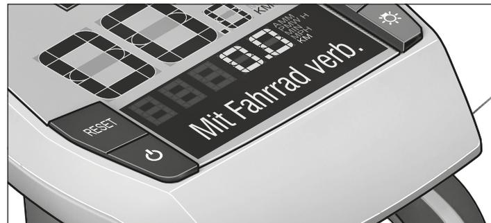
Abb.: B-9 Wenn der interne Akku des Bediencomputers leer ist, wird beim Einschalten „Mit Fahrrad verb.“ angezeigt.
