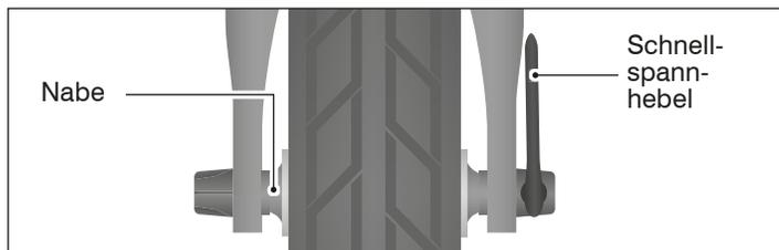
Abb.: H-8 Schnellspannachse am vorderen Laufrad.
