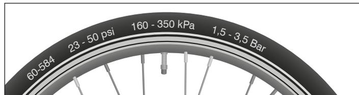
Abb.: E-19 Reifen mit Angabe der Reifengröße (60-584) und des minimalen und maximalen Luftdrucks in psi, kPa und Bar (exemplarisch).
