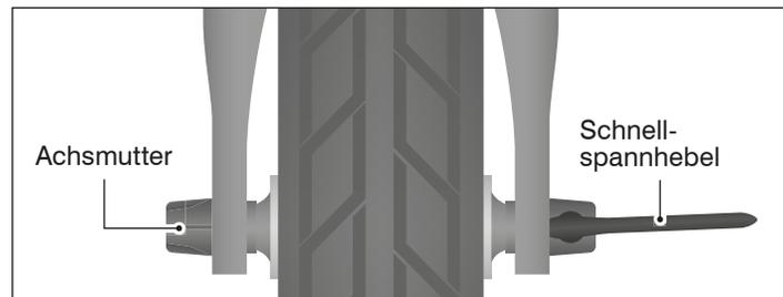
*Abb.: E-5 Geöffnete Schnellspannachse am Vorderrad.*
