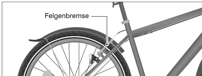
Abb.: H-4 Felgenbremse am hinteren Laufrad.
