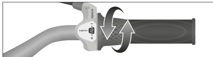
Abb.: B-8 Drehgriffschalter der Nabenschaltungen „Nexus“ (exemplarisch).
