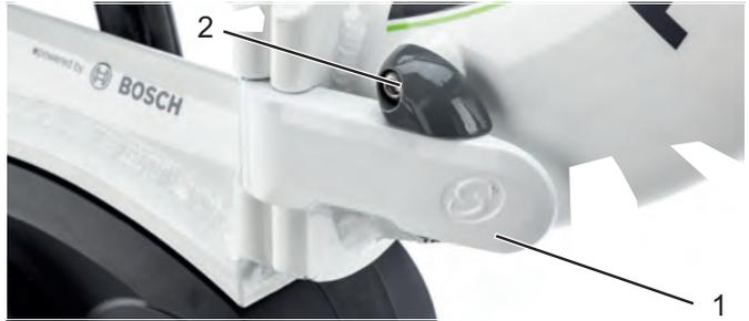
Abbildung 52: Rahmen, mit geschlossenem Rahmen-Spannhebel (1) und geschlossenem Rahmen-Sicherungshebel (2)
