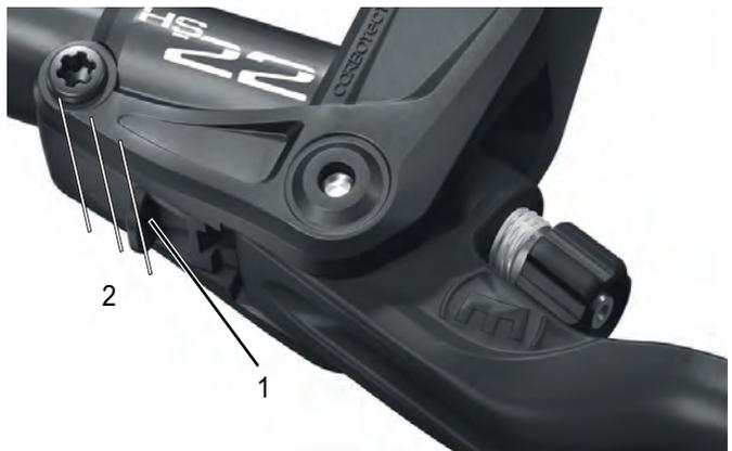
**Abbildung 6: Bremshebel mit Schieber (1) und seinen drei Positionen (2)**
